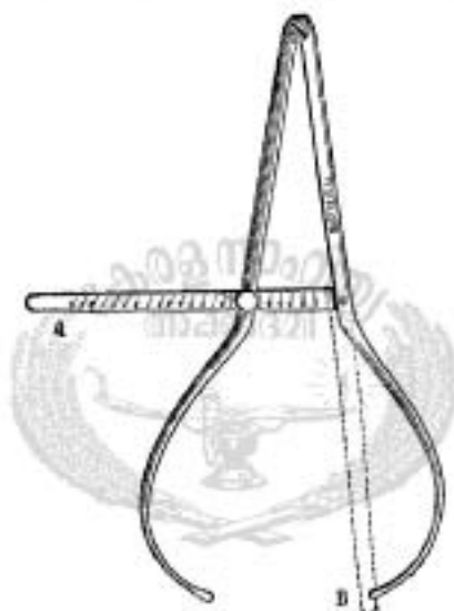
FIG. 26.—The Callipers (Compas d'Épaisseur).
